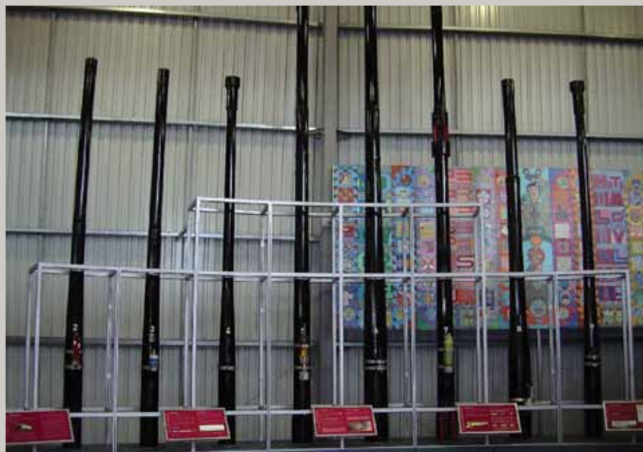
קבוצת קנים של תותחים, ואליהם צמודים קלעים שונים. מספר 5 הוא תותח ניסויי בקוטר 120 מ"מ, מספר 6 הוא תותח 120 מ"מ מסוג L1, מספר 7 תותח 120 מ"מ L11, מספר 8 תותח ניסויי 120 מ"מ עבור טנק MBT-80
